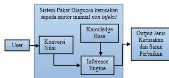
Gambar 3.1 Blok Diagram Sistem Pakar Kerusakan Sepeda Motor Manual Noninjeksi
