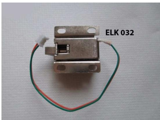
Gambar 1. Bentuk Fisik *Solenoid*
