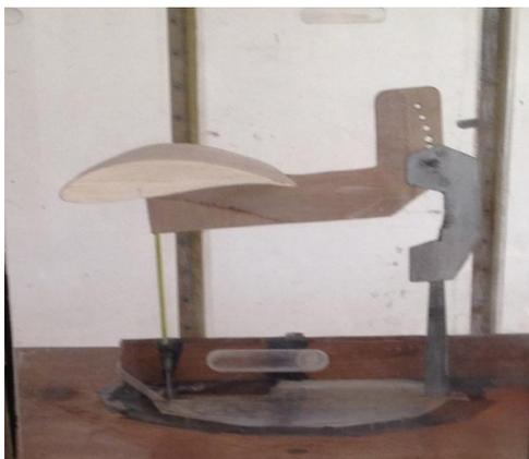
Gambar 7 Airfoil pada saat di terowongan angin.
