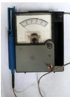
Gambar 3 Tampilan prototipe alat pengukur kecepatan angin
