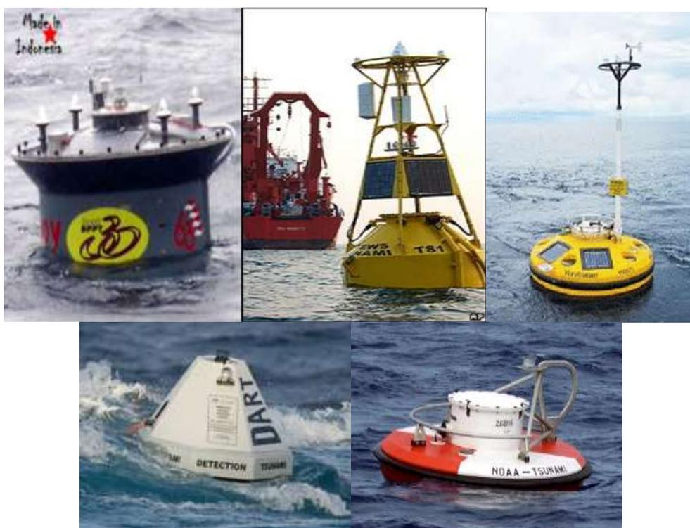
Gambar 1. Perangkat Tsunami Buoy di Indonesia
