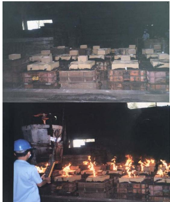
Gambar 10 Pengecoran Body Bom
