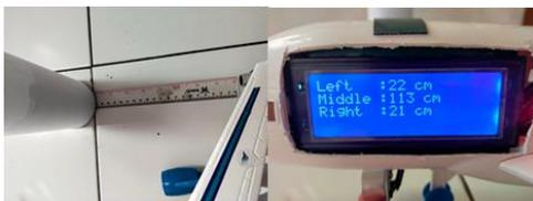
Gambar 6 Pengujian Sensor Ultrasonik HC-SR04
