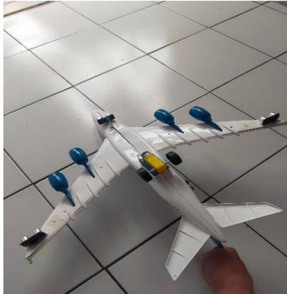
Gambar 3 pemasangan Alat *Detector* FOD Pada Pesawat Berbasis Mikrokontroler Arduino
