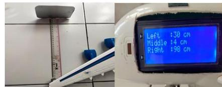
Gambar 5 Pengujian Sensor Ultrasonik HC-SR04
