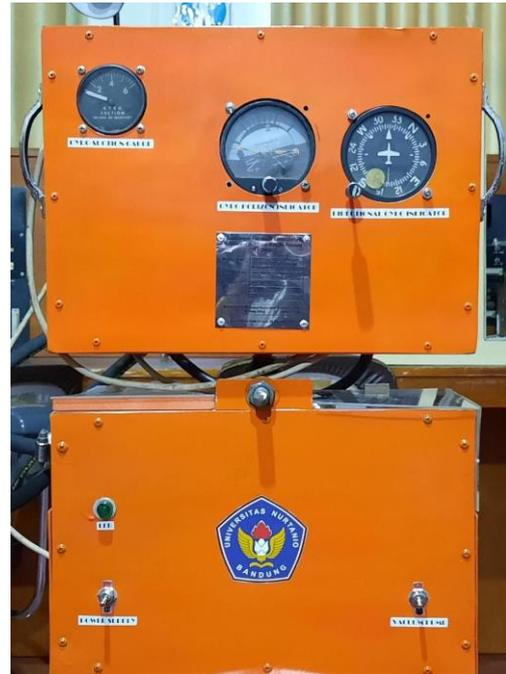
Gambar 7. Sistem Alat Uji setelah Terpasangnya GHI dan DGI
