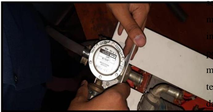
Gambar 4. Pemasangan Komponen *Pressure Regulator*
