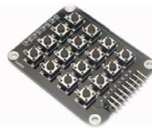
Gambar 5 Perangkat Keras Keypad Komponen Lampu Pijar
