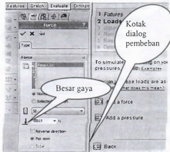
Gambar 8. Kotak dialog pembebanan pada simulasi Solid Works Nose bay side plate
