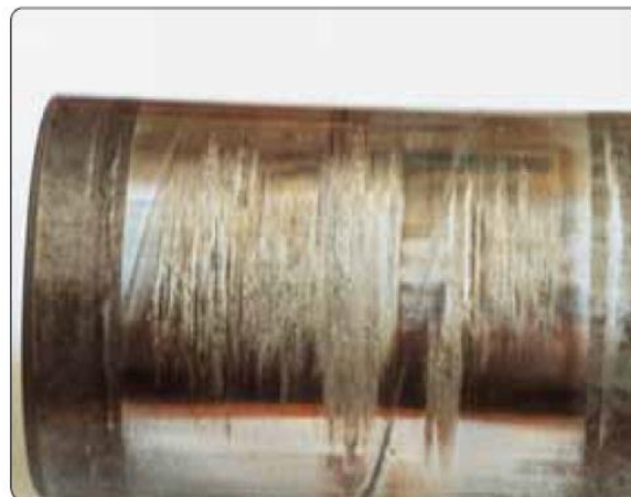
Gambar 2 : Bearing roller yang mengalami gesekan akibat kurang pelumasan
