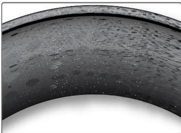
Gambar 1 : Bearing cup yang terkontaminasi partikel halus.
