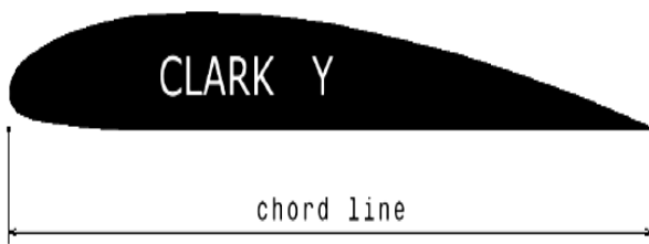
Gambar 2 Chord line dari Airfoil WIG-2 seater
