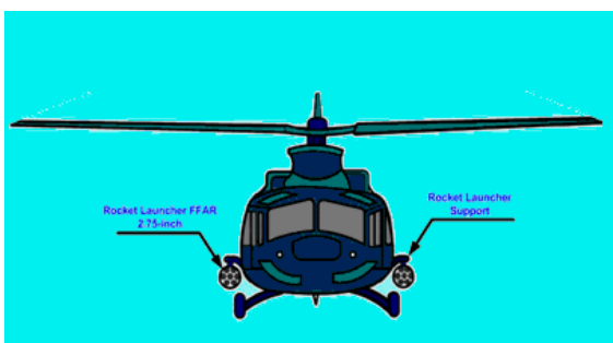
Gambar 1 Instalasi Roket pada Helikopter Bell 412
