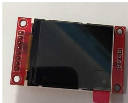
Gambar 2.3. LCD TFT 1,8 Inch
