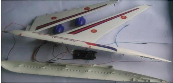
Gambar 10 Pemasangan rangkaian pada mainan pesawat
