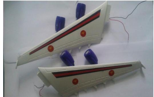
Gambar 9 Bagian ujung sayap yang telah dipasang LED
