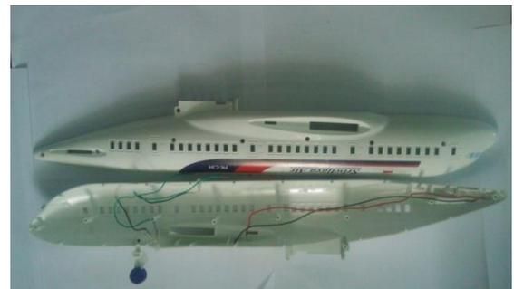
Gambar 10 Pemasangan *wire* dan LED pada *fuselage*
