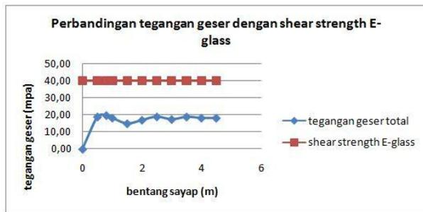
Gambar 6 Perbandingan tegangan geser dengan shear Strength E-glass
